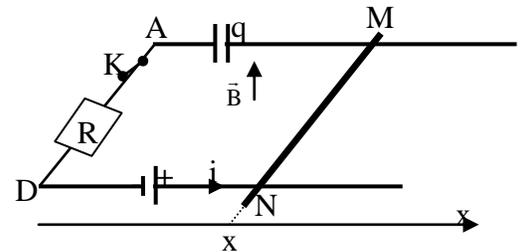
À la date  $t_0 = 0$ , (C) étant déchargé, on ferme K. À une date  $t$ , le circuit est parcouru par un courant d'intensité  $i$ , (C) porte la charge  $q$  et présente à ses bornes une tension  $u_{MA} = u_C$ . MN, repérée par son abscisse  $x$  et subissant l'action de la force de Laplace  $\vec{F}$ , possède une vitesse  $\vec{V}$  de mesure algébrique  $V = \frac{dx}{dt}$ . Le circuit est ainsi orienté dans le sens de  $i$ .
